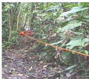
Figuras 8 y 9. Geófono colocado en líneas receptoras. Cable de línea sísmica o ristra.
